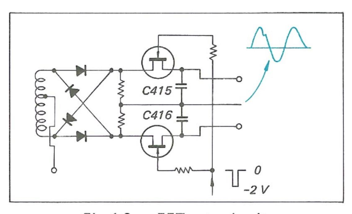
Fig. 1-9. FET gate circuit
