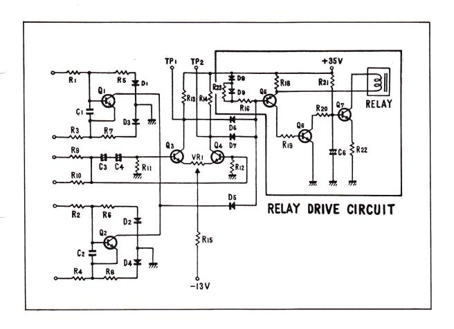
9. THE PROTECTION RELAY IS DRIVEN BY A SCHMIT TRIGGER CIRCUIT CONSISTING OF Q-5, Q-6 AND Q-7.
