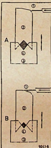
Figuur 5: Schematische voorstelling KODAK BROWNIE „Starmatic“ A weinig licht B veel licht 1 meternaald 2 bovenste diafr. lamel 3 onderste diafr. lamel 4 lensopening
