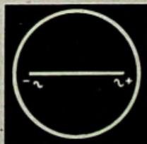
Fig. 5: wisselspanning op horizontale platen.
