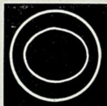
Fig. 17: Amplitudeverschil. De spanning op de horizontale platen is groter dan die op de verticale
