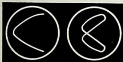
Fig. 22 Fig. 23 Frequentieverhouding 1:2, echter met een faseverschulving van resp. 180^\circ en 135^\circ .
