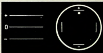
Fig. 3: gelijkspanning op de verticale platen.
