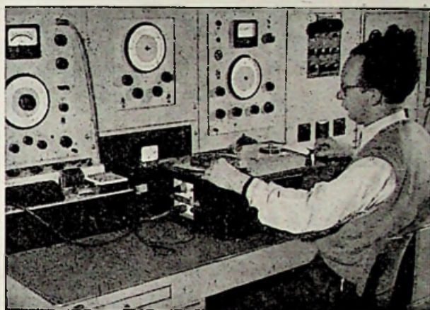
Onder : Fig. 12. Installatie voor de electro-acoustische controle van de magneetband.
