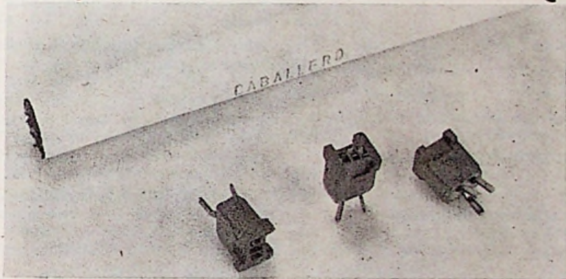
Transistorvoetjes zijn onmisbaar voor degenen, die de experimenten met de transistor wil uitvoeren, terwijl ze ook een bescherming vormen tegen verbranding bij het solderen. Het type B8.600.01/00 (Philips) kost f 0.45.
