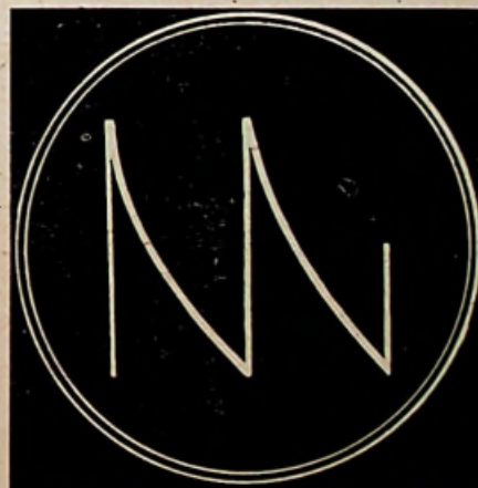
Fig. 4. De neon-oscillator levert ons een zaagtandgolfvorm volgens bovenstaande afbeelding.
