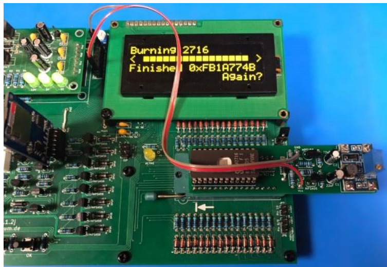
Abbildung 4.4: 2716 EPROM mit Adapter
