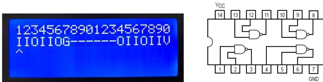
Abbildung 3.107: Definition eines 7400 (4-fach NAND)
