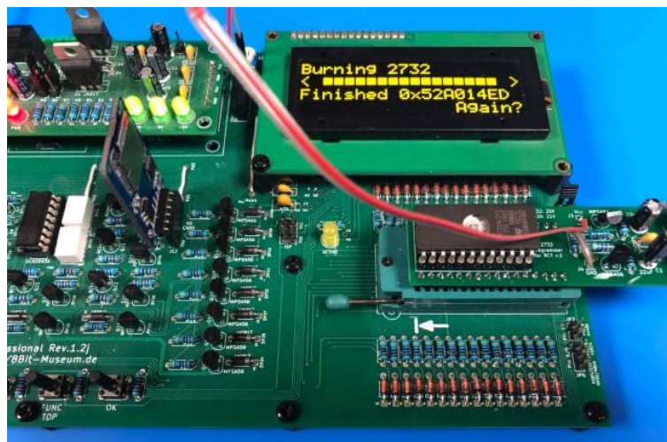
Abbildung 4.5: 2732 EPROM mit Adapter
