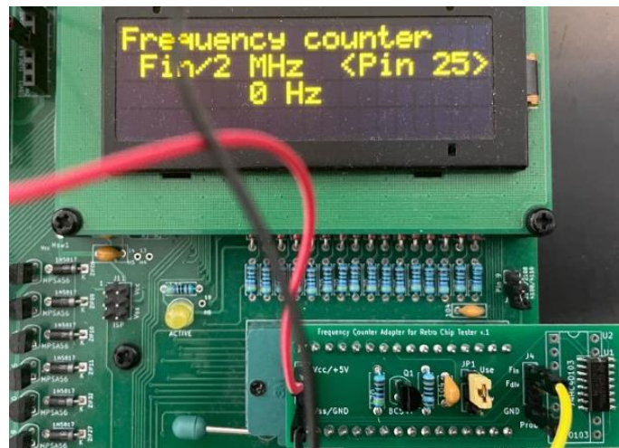
Abbildung 3.118: Frequenzzähler („Fin“ Modus, bis 2 MHz)
