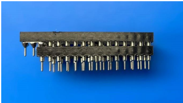
Abbildung 3.68: DIY Adapter zum Lesen der Signatur von EPROMs mit 32 Pins
