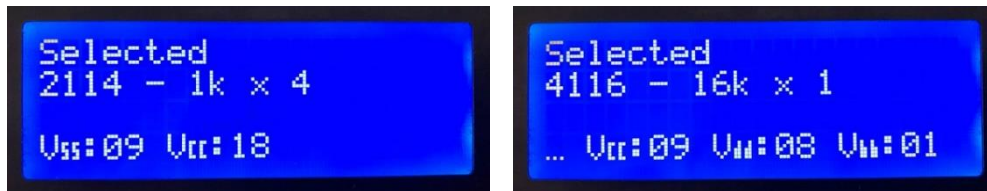
Abbildung 3.3: Beispiele: Auswahl eines „2114“ SRAM bzw. „4116“ DRAM
