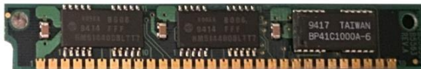
Abbildung 3.9: SIMM mit Emulation des Paritätsbits
