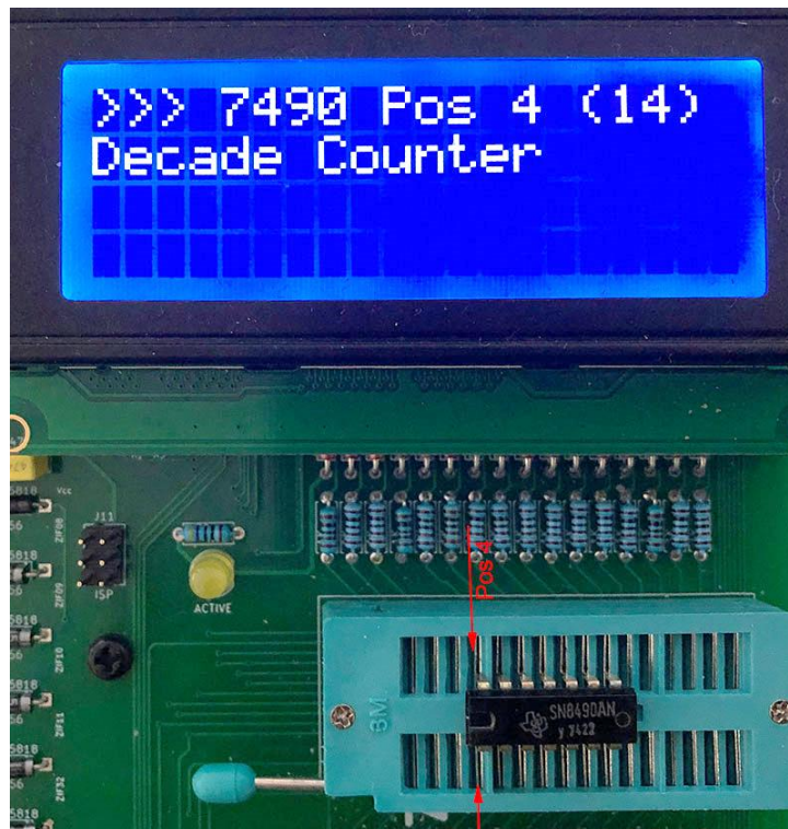
Abbildung 3.2: Chip eingesetzt an Position 4 (7490)
