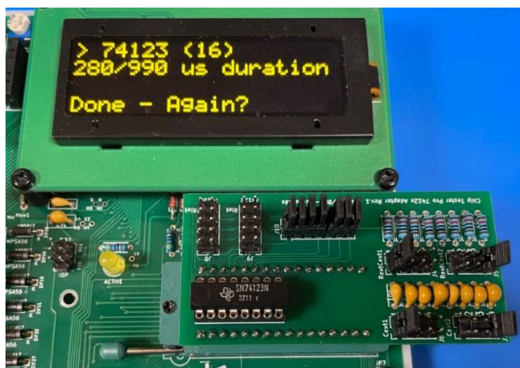
Abbildung 3.96: 74123 mit gesetzter Pos 1 und Pos 3
