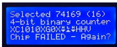
Abbildung 3.74: Defektes „4-bit binary counter (74169)“
