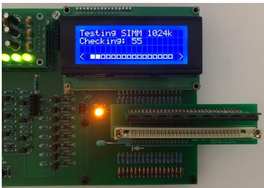
Abbildung 3.8: Adapter im Sockel
