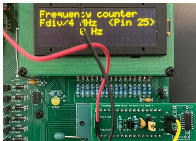
Abbildung 3.119: Frequenzzähler („Fdiv“ Modus, bis 32 MHz)
