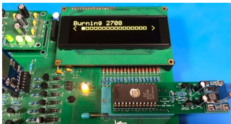
Abbildung 4.3: 2708 EPROM mit Adapter
