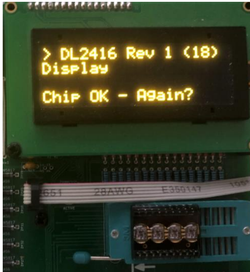
Abbildung 3.76: Chip um 180 Grad gedreht an Pos 1 eingesetzt (DL2416)
