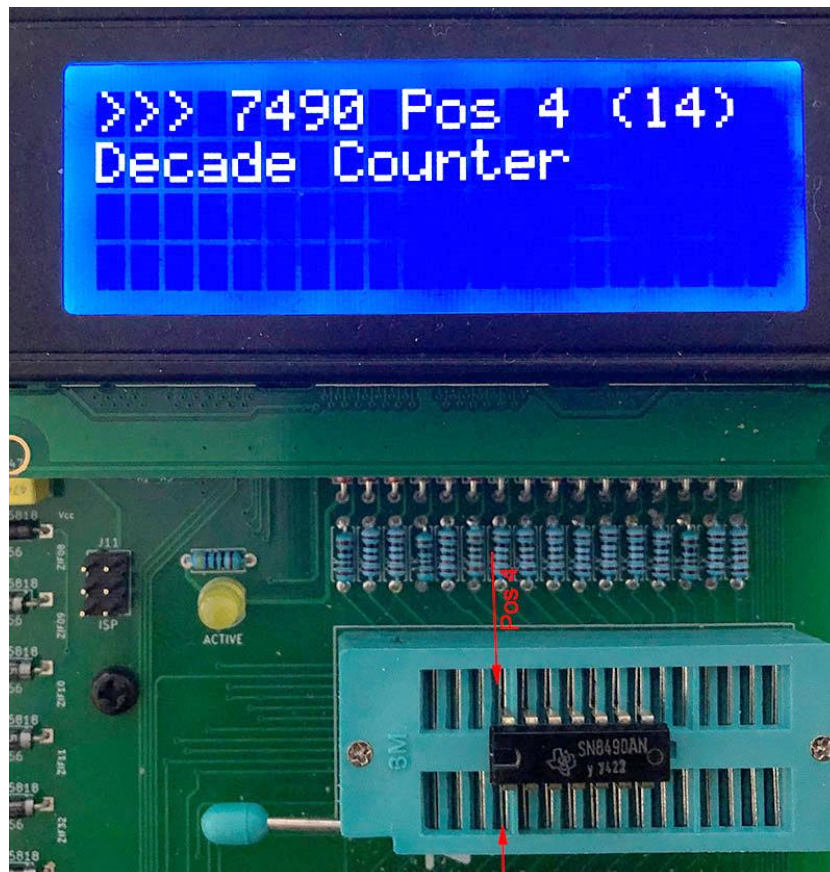
Abbildung 3.75: Chip eingesetzt an Position 4 (7490)
