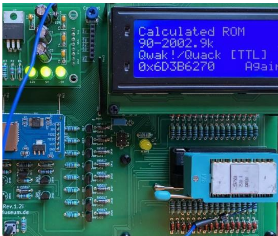
Abbildung 3.50: Auslesen eines 2530 ROM
