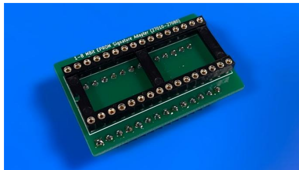
Abbildung 3.69: Adapter zum Lesen der Signatur von EPROMs mit 32 Pins
