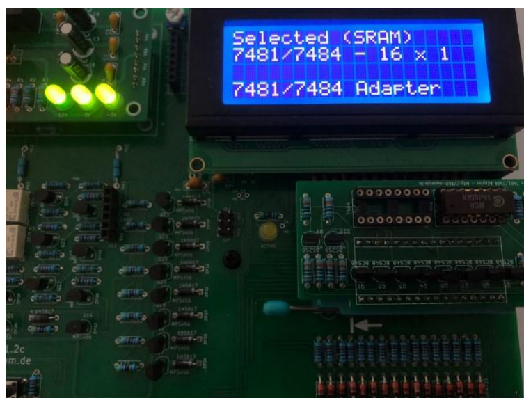
Abbildung 3.19: Adapter im Sockel
