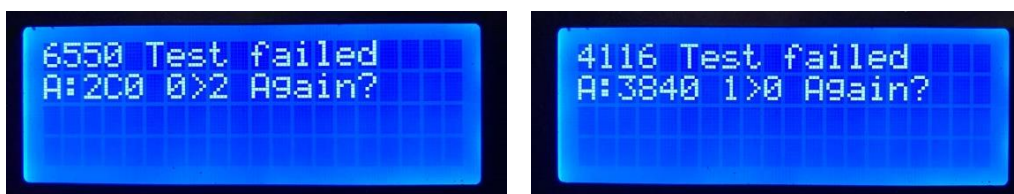
Abbildung 3.5: Fehlgeschlagene Tests eines 6550 (erwartet b0000, gelesen b0010) an Adresse 0x02C0 und 4116 (erwartet 1, gelesen 0) an Adresse 0x3840
