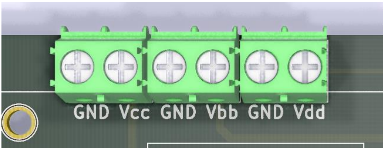
Abbildung 3.5: Belegung der Schraubterminals ( V_{cc} = 5V , V_{bb} = -5V , V_{dd} = 12V )
