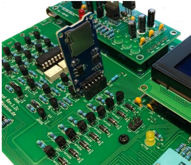
Abbildung 6.1: SD-Kartenadapter in der bestückten Pfostenleiste
