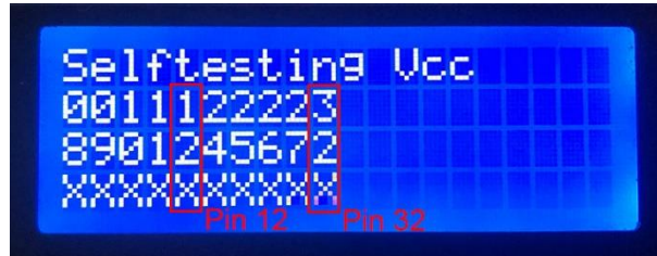
Abbildung 8.18: Test von Vcc, Interpretation der Anzeige
