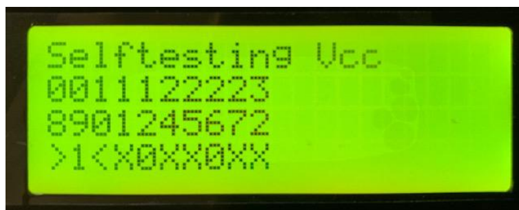
Abbildung 8.19: Fehler beim Test von Vcc
