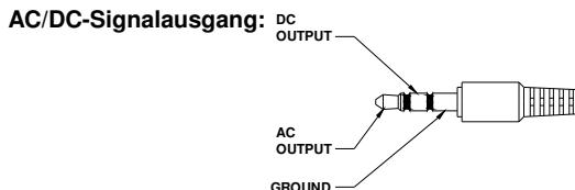
AC: Ausgangsspannung: 1Vrms entsprechend jedem Bereichsschritt.
